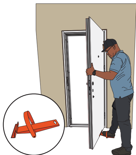
STEP 10. Dørbladet hænges på hængslerne.
