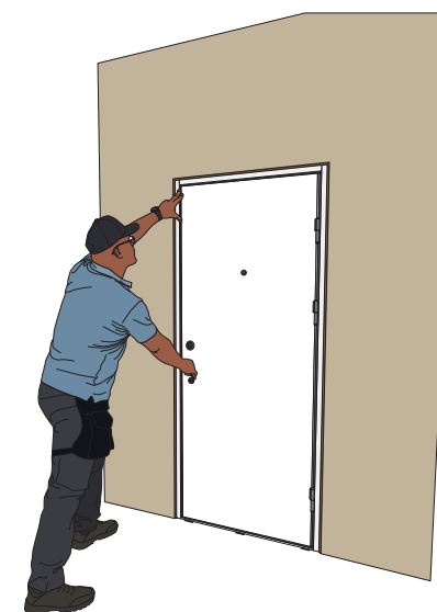
STEP 12. Kontroller lukkefunktionen og tætningen.
